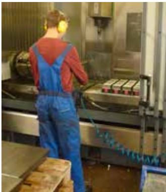
Ein Beschäftigter beim Säubern des Arbeitsraums der CNC vor dem Einlegen des nächsten Werkstücks
